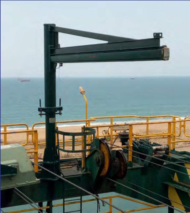
Une grue flèche fixée sur le « boom tip » d'une grue STS de LCT
