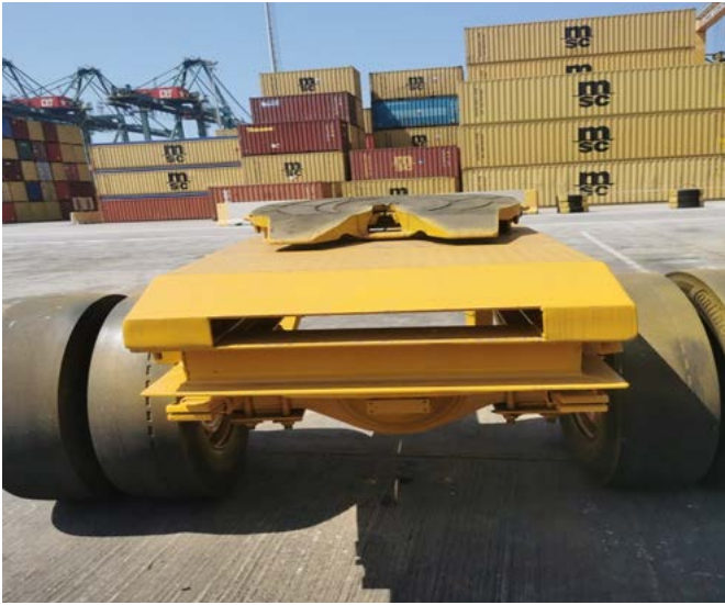
Un Dolly, pourvu d'un dispositif d'accrochage
